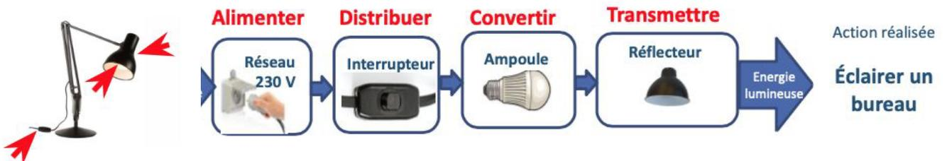
La **chaîne d'énergie** représente l'**ensemble des éléments** qui participe à la **circulation de l'énergie** dans un objet technique pour **obtenir son fonctionnement**. On complète la **chaîne d'énergie** d'un objet technique en **associant chaque élément** de l'objet à **une fonction** de la chaîne d'énergie : **alimenter - stocker - distribuer - convertir - transmettre**.
